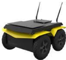
Kuva 14 Jackal on Clearpathin pieni, ketterä ja aloittelijaystävällinen kenttärobotiikan tutkimusalusta. [51]
