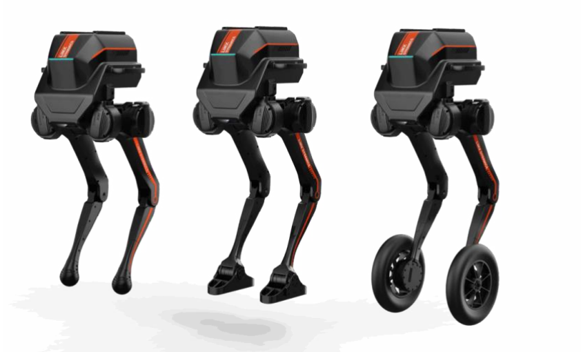
Kuva 2 LimX Dynamicsin TRON1: monimuotoinen kaksijalkainen robotti, jossa vaihdettavat Point-Foot-, Sole- ja Wheeled-jalat. [24]
