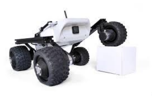
Kuva 13 Leo Rover on Fictionlabin kehittämä modulaarinen ja ROS-yhteensopiva UGV [50]
